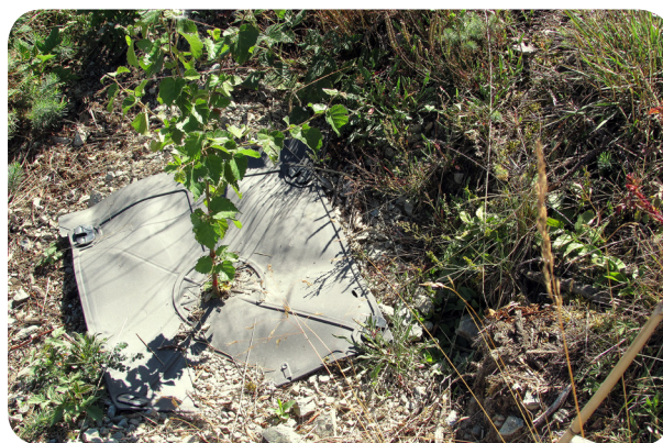
Photos 35 et 36. Nouveau paillis fait de biopolymère, en deux versions. À gauche : cadre fixé sur un biofilm commercial. À droite : paillis fabriqué intégralement à partir du nouveau biopolymère
