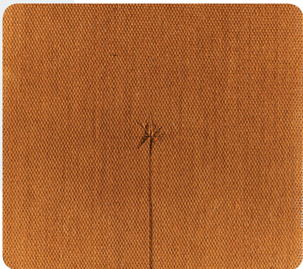
Photos 37 et 38. Paillis biodégradable de jute traitée avec de la résine organique
