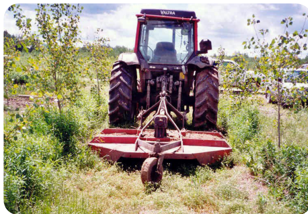
Photos 19 et 20. À gauche : débroussaillage mécanique manuel avec une débroussailleuse. À droite : débroussaillage mécanique avec un broyeur à axe horizontal actionné par un tracteur (auteur : M Burgess)
