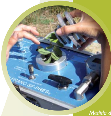
Medida del potencial hídrico con cámara de presión
